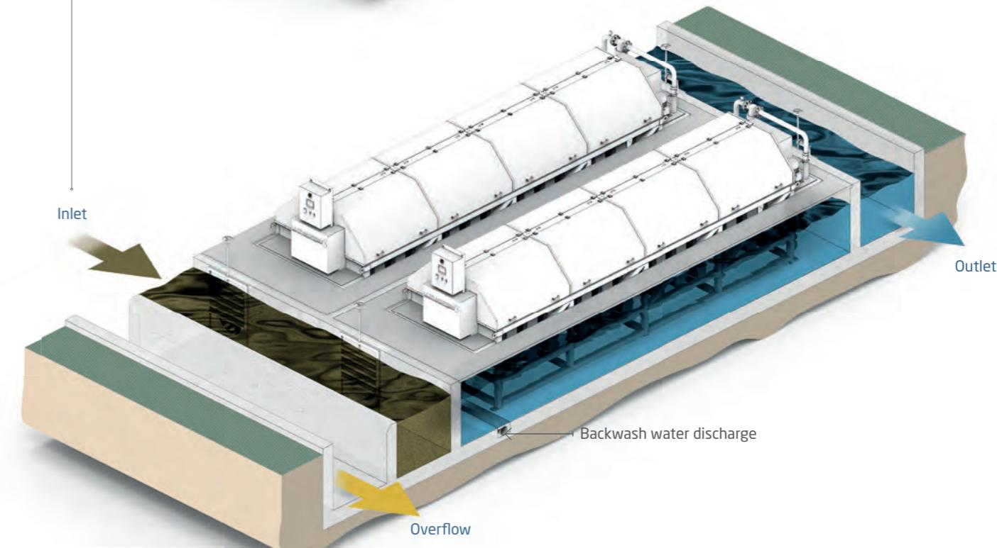
Nel microfiltro Ultrascreen® le possibili combinazioni dei tronchetti di alimentazione, scarico e acque di controlavaggio sono molteplici.
